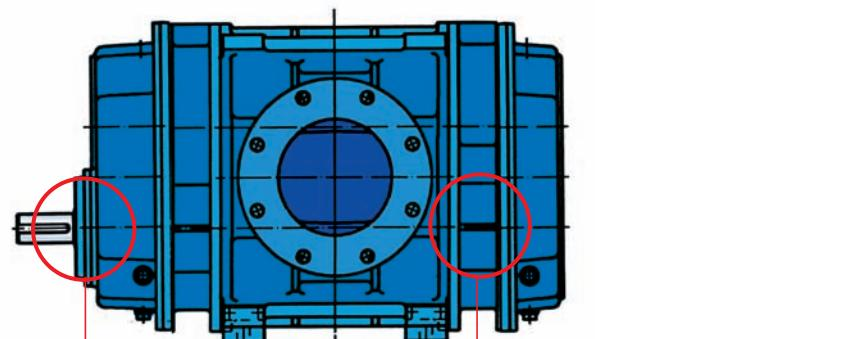
Etanchéité en sortie d'arbre
